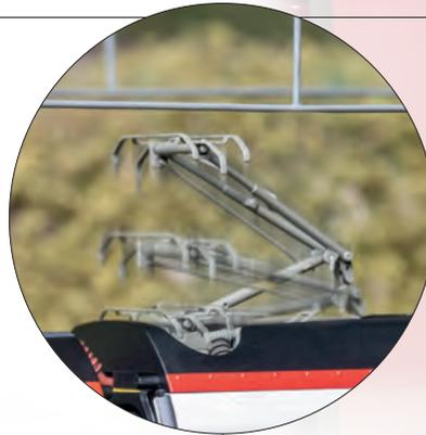
Stromabnehmer auf den Mittelwagen F und H über Digital-Funktion heb- und senkbar
