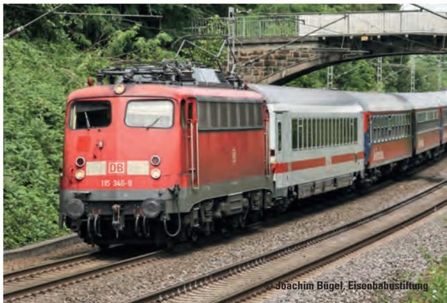
Hervorgegangen aus der Baureihe 110 wurde die BR 115 hauptsächlich für den Autoreiseverkehr eingesetzt. Nachdem die ursprüngliche Verwendung als Gepäck- und Postzuglokomotive zurückging. Später sah man sie auch im Personenverkehr.
